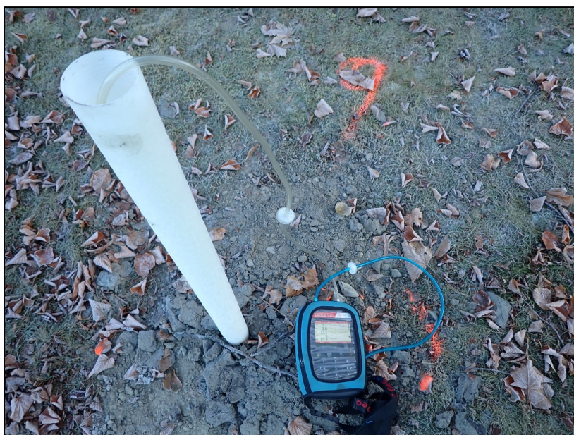
Figur 16 Gassmåling i miljøbrønn.
