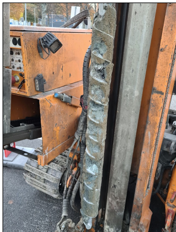
Figur 19 Prøvepunkt SPA4 2-3 meter. Leire med mørk treflis over tørr leire.
