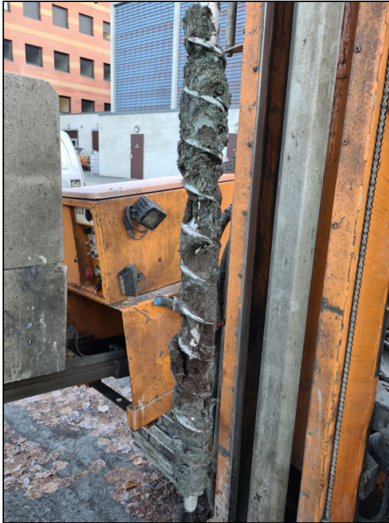
Figur 20 Prøvepunkt SPA6 1-2 meter. Leire med oljelukt over torvjord med oljelukt.
