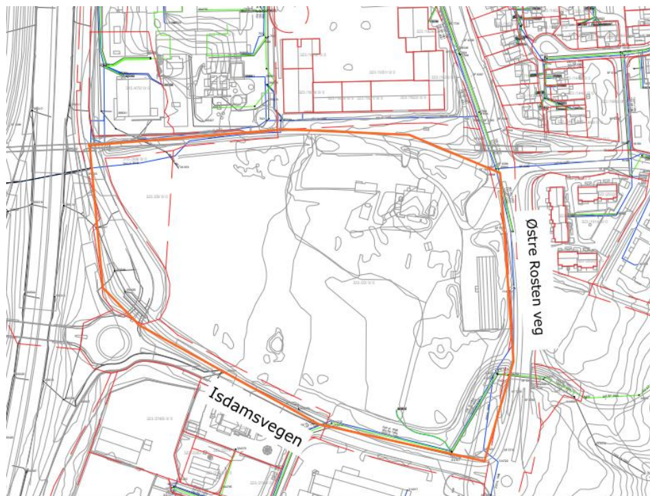
Figur 2 Eksisterende situasjon av VA-nett. Plangrense er gitt av oransje linje. Eiendomsgrenser merket rød/stiplet
