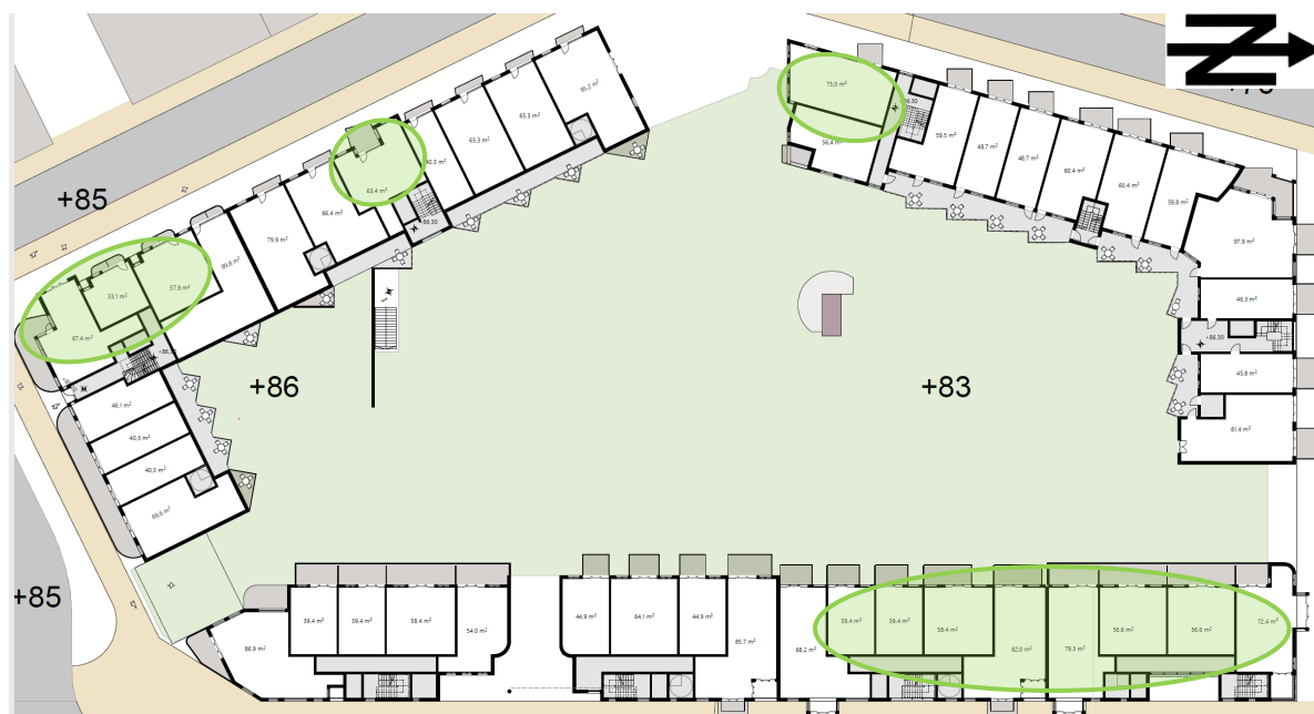
Figur 17 - Typisk planløsning for boligblokkene i situasjon B med markering i grønt hvor det vil være aktuelt å åpne for bruk av dempet fasade. Hvor mange leiligheter det vil være nødvendig å bruke dempet fasade avhenger av etasje
