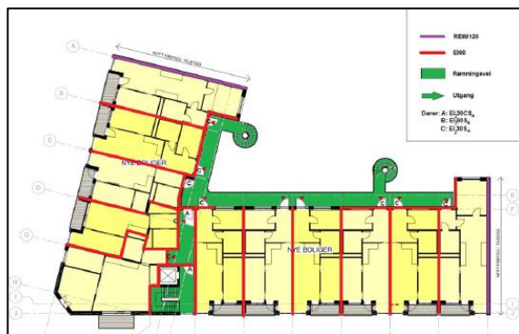
Figur 39 Brannplan for 4. og 5. etasje. Fra brannnotat.
