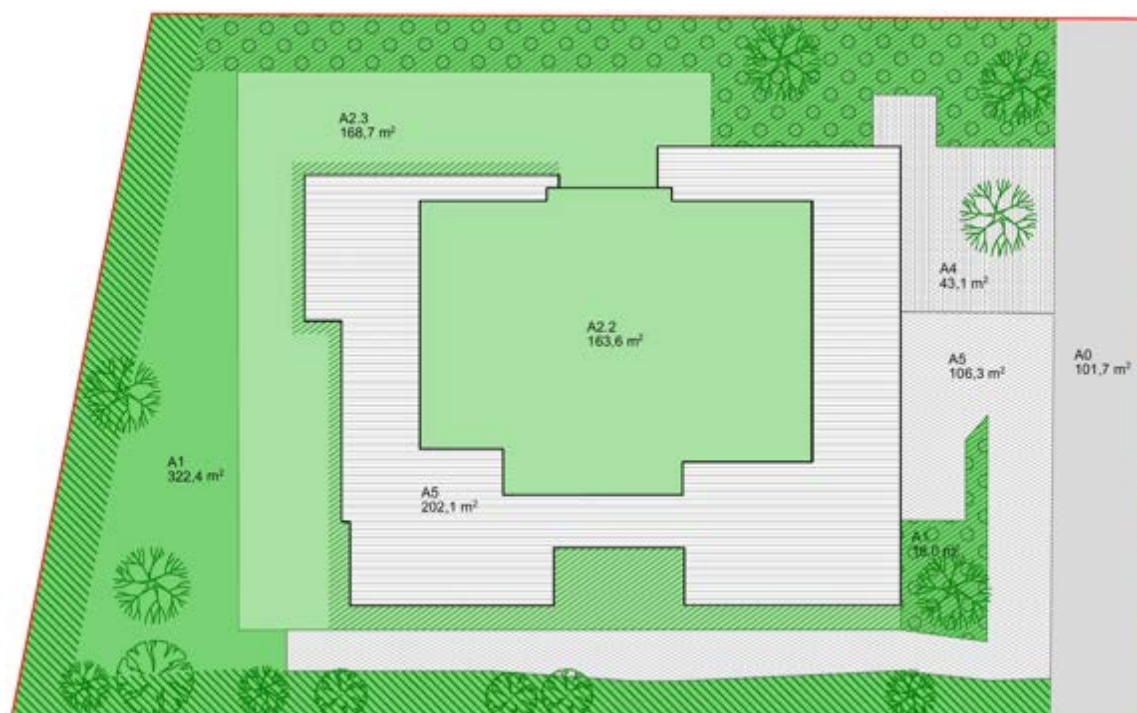
Figur 25, illustrasjon av hvordan prosjektet oppfyller blågrønn faktor. Se eget vedlegg «453 Illustrasjonsprosjekt blågrønn faktor.pdf» for fullstendig tegnforklaring.
