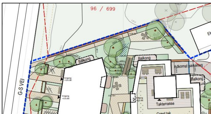
Figur 24: Uterom nord, universelt utformet med trinnfri adkomst fra Byåsveien.
