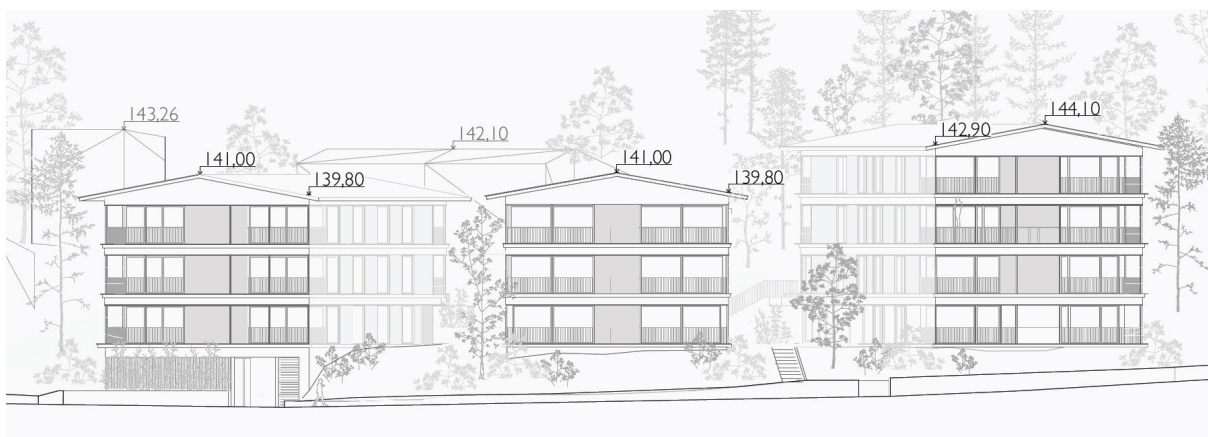
Figur 2: Fasadeoppriss etter revisjon
