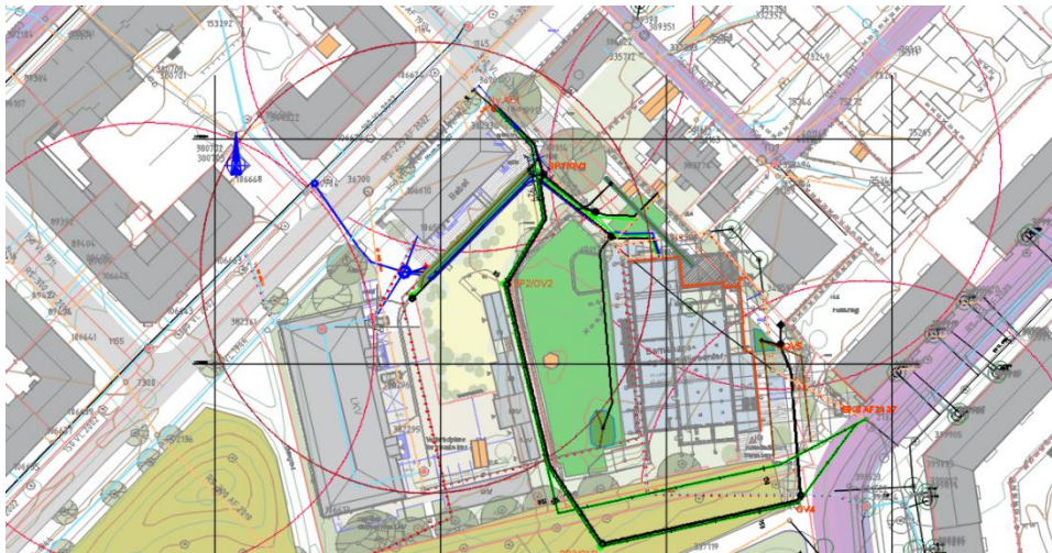
Figur 5 Utsnitt fra VA plan H100 som viser innlagt brannvannssirkler med radius 50 meter.
