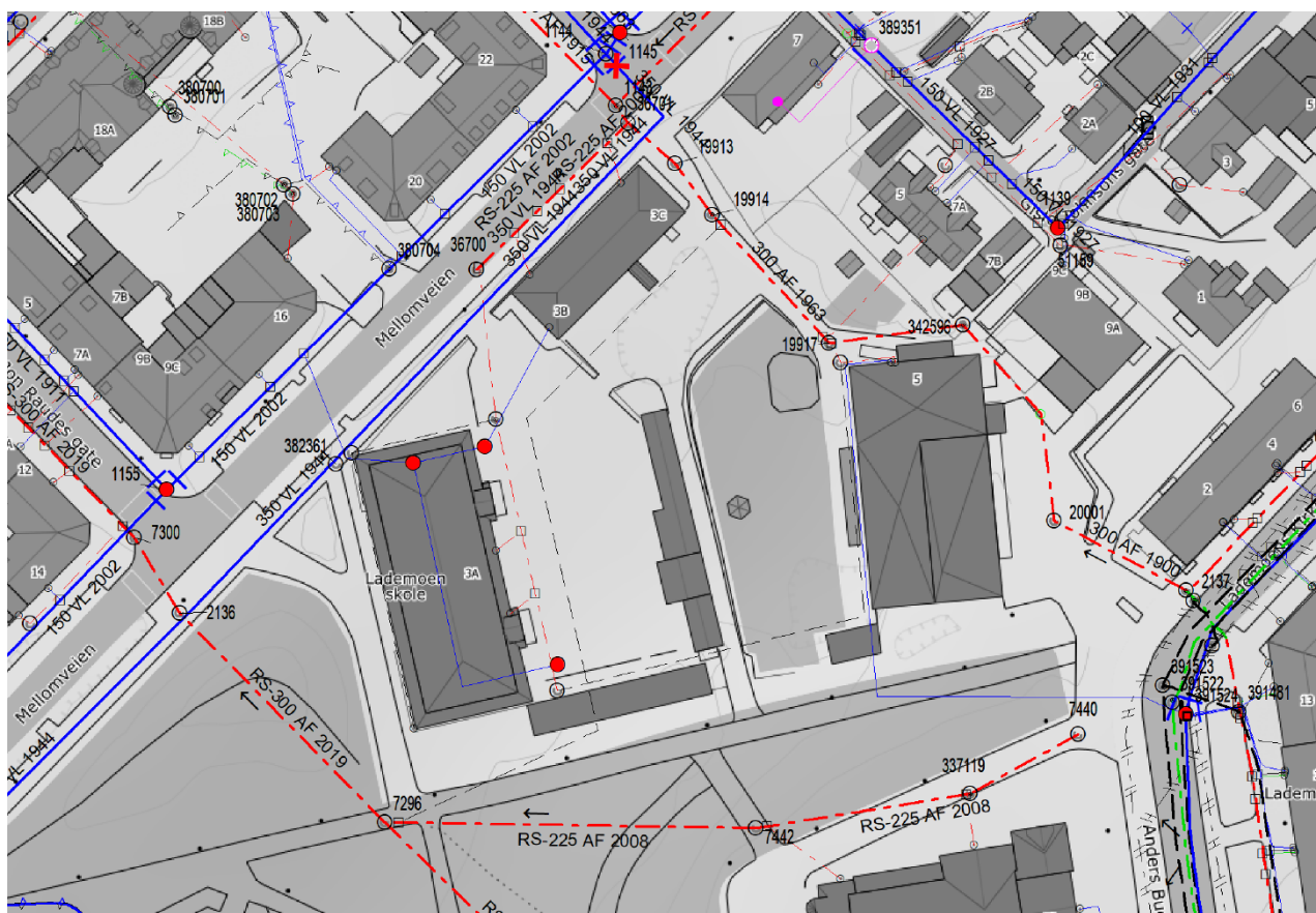
Figur 4 Utsnitt fra VA kart som viser eksisterende VA ledninger
