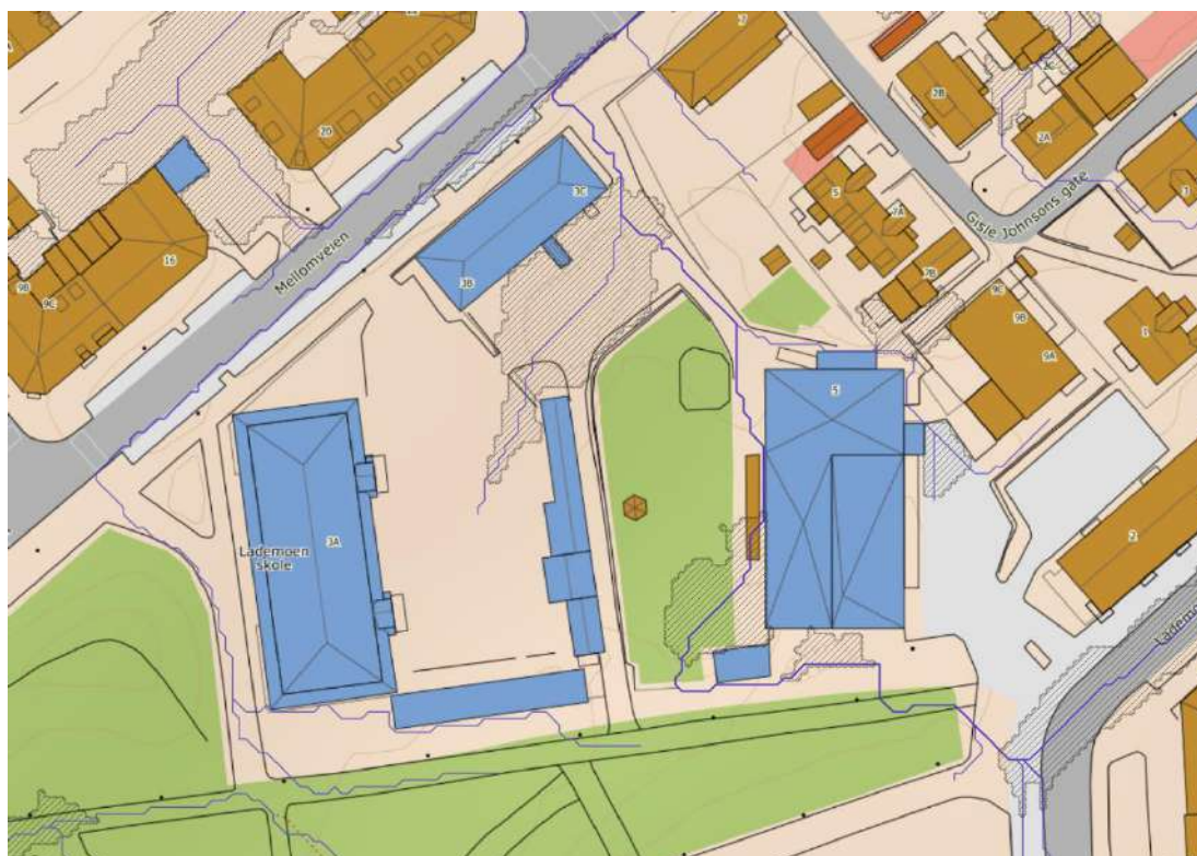
Figur 8 Eks. situasjon med flomveier ved Voldsminde barnehage, hentet fra Scalgo.
