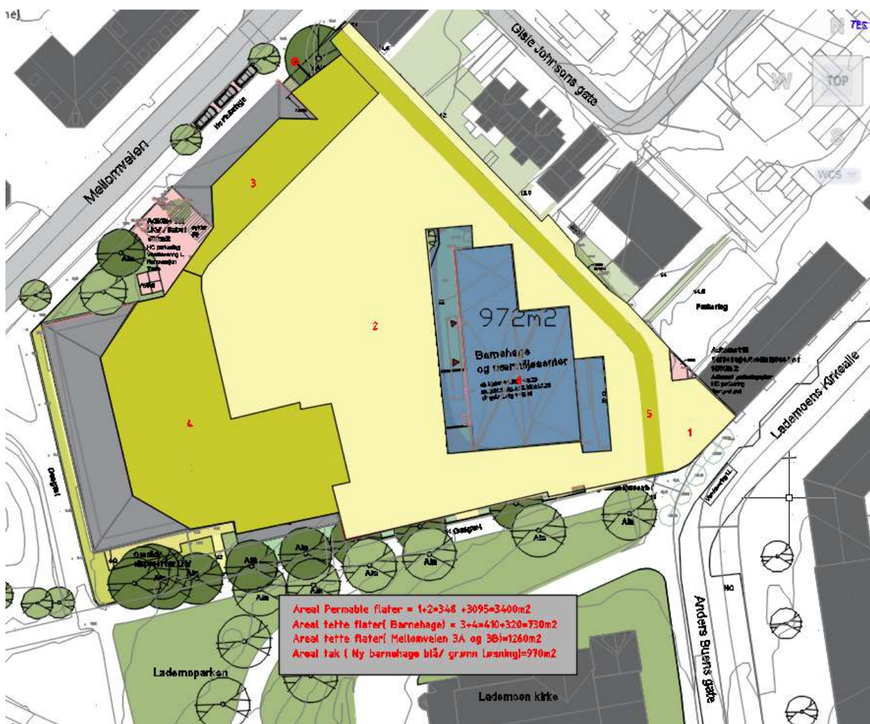
Figur 6 Skisse som viser permeable/ tette areal.
