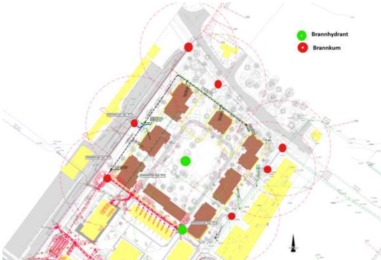
FIGUR 4 BRANNHYDRANTER OG KUMMER, RØD, GRØNNE RINGER HAR RADIUS PÅ 50 METER
