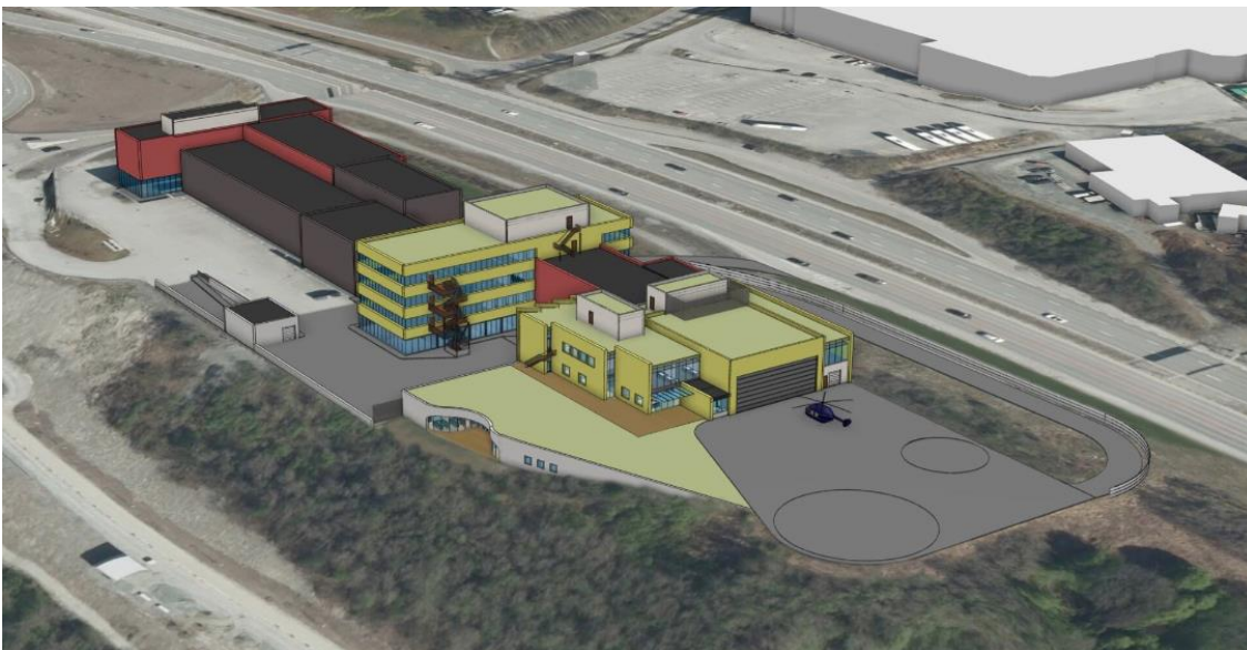
Figur 4-4: Illustrasjon av det planlagte tiltaket. Eksisterende bebyggelse er vist med rød, brun og svart farge. Planlagt utvidelse av hovedbrannstasjonen (tilbygget) er også vist med brun farge.
