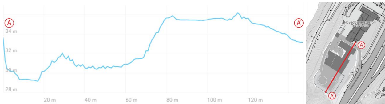
Figur 7. Terrengprofil for influensområdet mellom nybygg mot nord og helikopterlandingsplass mot sør.
