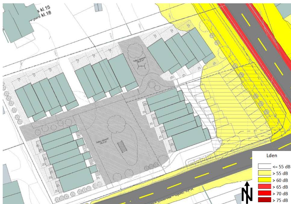
Figur 4 - Beregnet støynivå L_{den} på uteoppholdsareal, 1,5m beregningshøyde.
