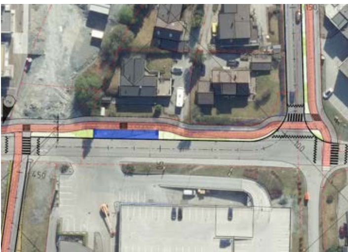
Figur 37: Alternativ løsning med sykkelveg med fortau på østsiden
