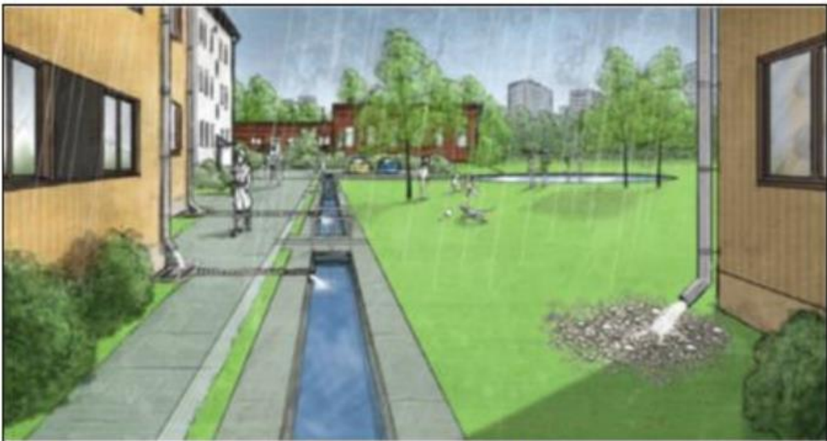
Figur 6: Håndtering av overvann fra taknedløp til ååen renne (fra Veileder for overvann OVA)
