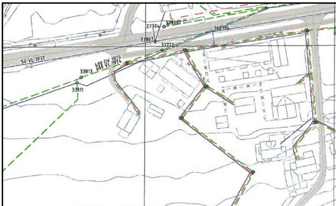
Ledningskart over eksisterende situasjon. Det ligger 200 mm spillvannsledning i Gamle Jonsvannsveien, i tillegg til 150/400 mm overvannsledning og 600 mm vannledning i vestre deler av planområdet.
