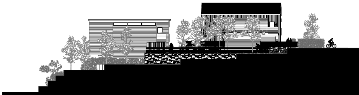
Snitt (over) som viser planlagt bebyggelse med støttemur i grensen mot Alupro-N, Turistveien 50a.
