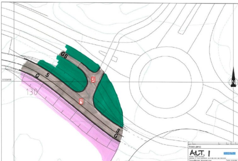
Løsning for sammenkobling mellom nytt og eksisterende gang- og sykkelveinett.
