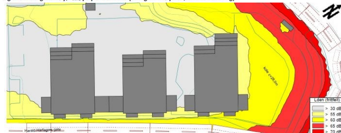
Figur 9 - Beregnet støy, L_{den} , på uteområdet uten skjermingstiltak (beregnet i høyde 1,5 m over terreng).
