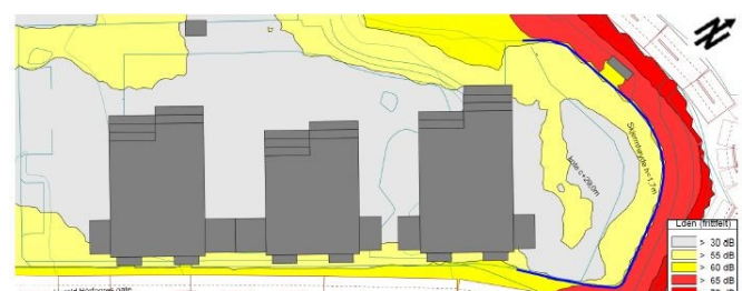
Figur 10 - Beregnet støy, L_{den} , på uteområdet med skjermingstiltak (beregnet i høyde 1,5 m over terreng).
