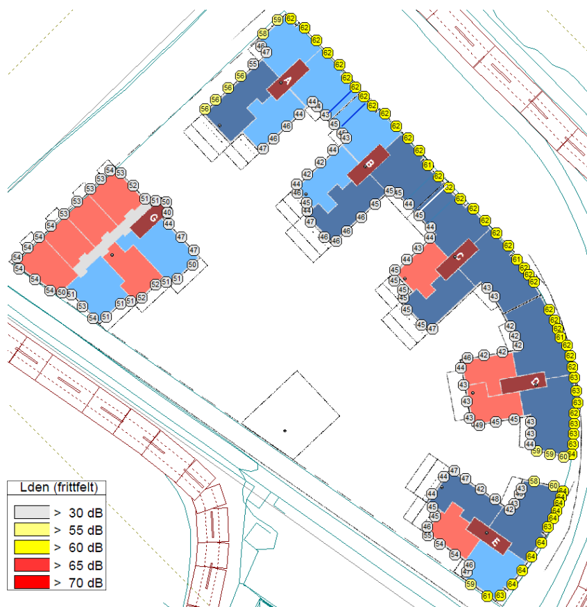
Figur 6 - Beregnet A-veid ekvivalent lydnivå for dag-kveld-natt, L_{den} , på plan 3
