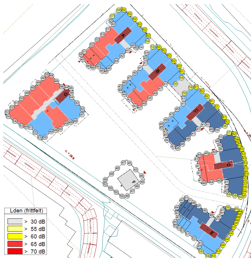
Figur 4 - Beregnet A-veid ekvivalent lydnivå for dag-kveld-natt, L_{den} , på plan 1
