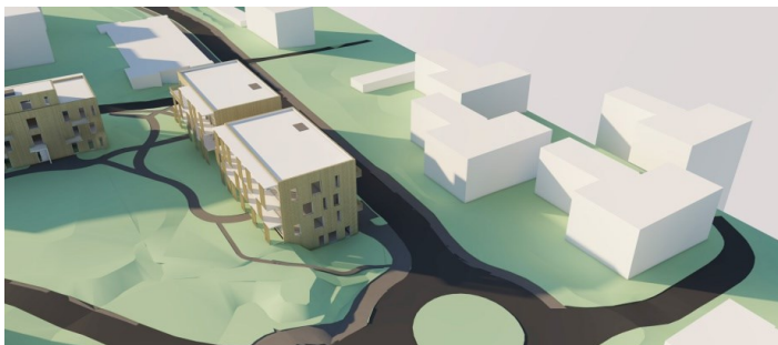
Figur 5 - Skyggevirkning på naboblokk nord for Leistadvegen 21. mars kl. 15.00
