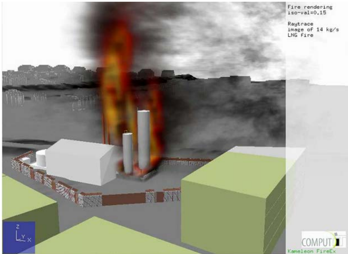
Figur 28: Antent 14 kg/s LNG spray (samme scenario som vist i Figur 17)
