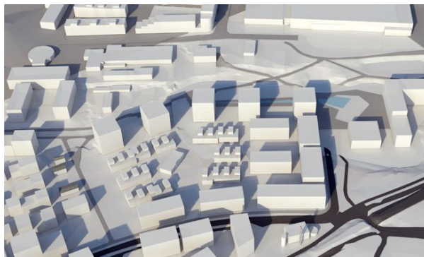
Alternativ 2 med åtte etasjes bebyggelse i nord og fem etasjer på de to lamellblokkene i sørvestre hjørne.
