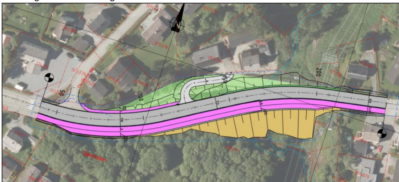
Vegskisse som viser skråningsutslag som følge av tiltaket
