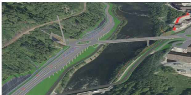
Figur 1. Kulvertløsning. Rundkjøring med kulvert under. Løsningen foreslås videreført
