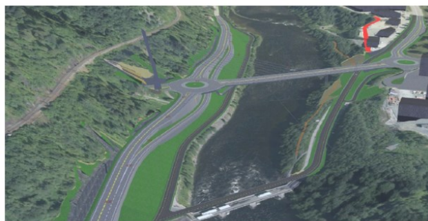
Figur 2. "Bypass"-løsning. Forbikjøringsfelt mot elva. Løsningen foreslås ikke videreført
