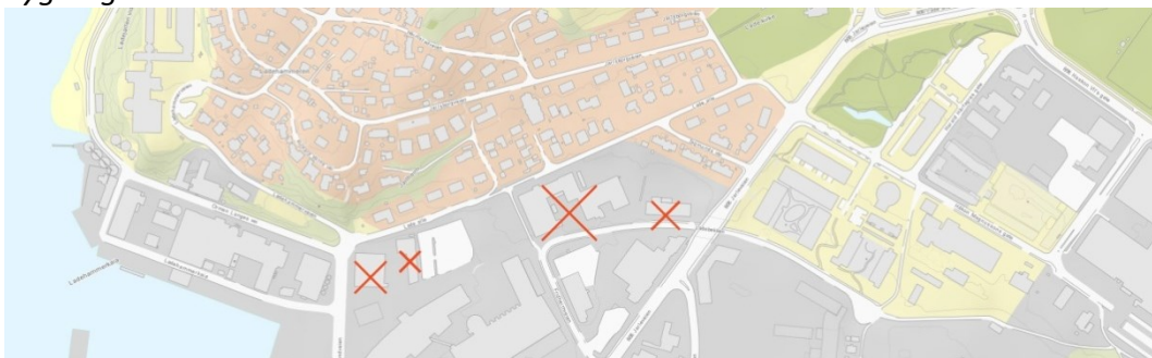
Figur 17: Eksisterende bygg som skal rives er vist med kryss. I tillegg må del av bygning i Ladebekken 6 (gnr 415/172) også rives fordi den går ut i den nye traseen til gata Ladebekken. Situasjonen for Ladebekken 6 ble vedtatt i forbindelse med områderegulering for Lilleby i 2013.
