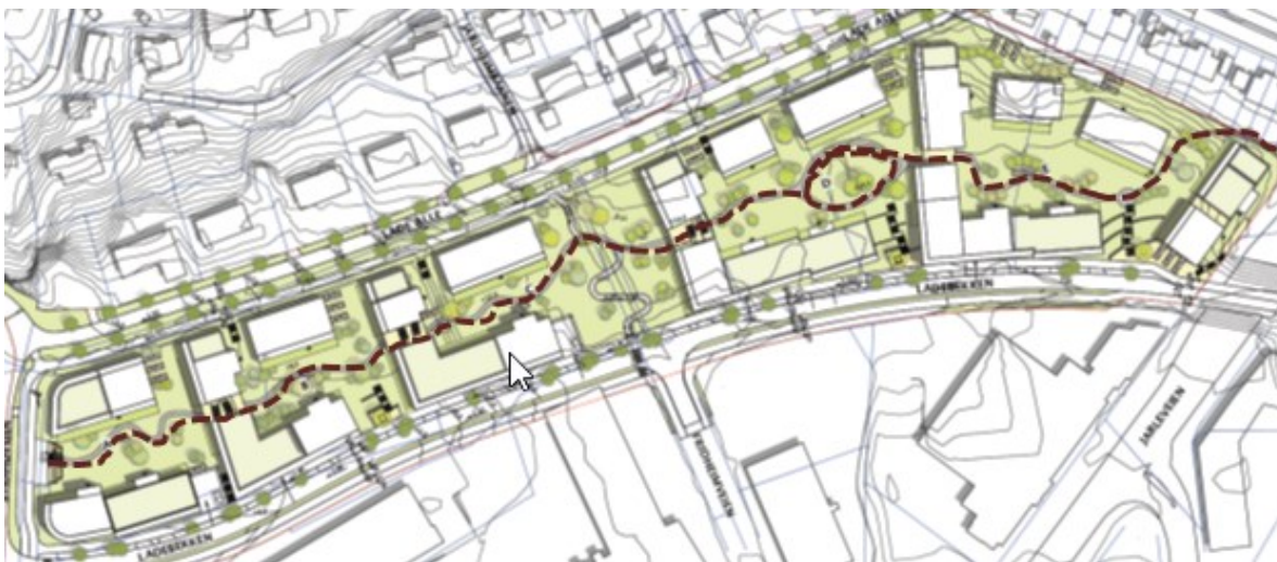
Figur 3: Fem ulike uterom med langsgående forbindelse gjennom planområdet, med bred trapp ned mot Strandveien. Universell utforming til forbindelsen blir fra Lade allé og heis fra parkeringskjelleren.
