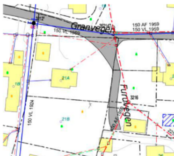
Eksisterende vann- og avløpsledninger
