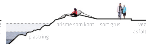
Principssnitt 1:200 - bearbeiding av plastring 1 Stort prisme i betong skjærer seg inn i plastringen og skaper sittemulighet ved vannet.
