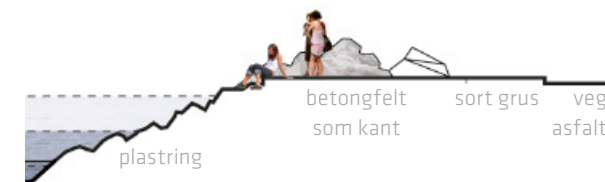
Principssnitt 1:200 - bearbeiding av plastring 2 Betongfelt skjærer seg inn i plastringen og skaper en flat kai med kontakt til vannet.
