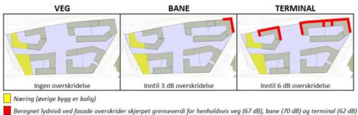
Figur 19: Viser hvilke fasader man overskrider de skjerpede grenseverdiene.
