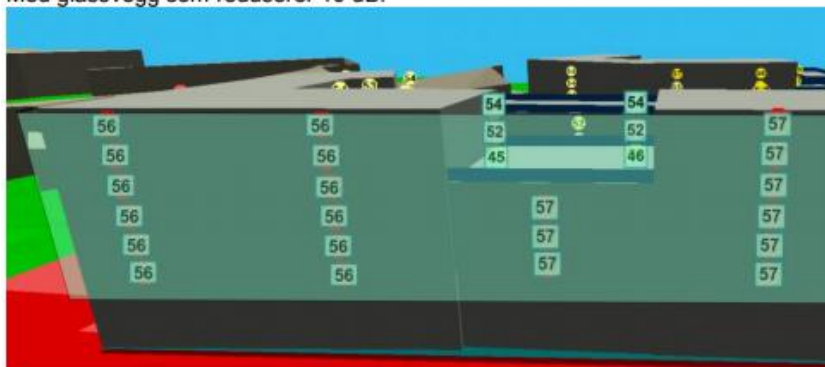
Figur 21: Illustrasjon som viser lydnivå på fasade med og uten skjermende støyvegg.
