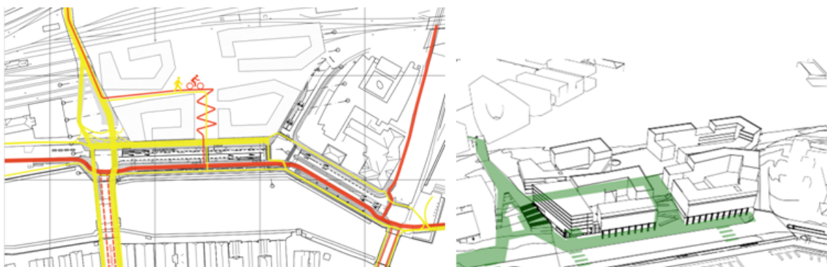
Figur 7 og 8: I figuren til venstre er rød linje prinsipptegning for hovedsykkeltrase i området og til høyre er en prinsippskisse som viser fotgjengerareal med brede fortau. Det er etter offentlig ettersyn i tillegg sikret opparbeidelse av en gang- og sykkelrampe fra lokket på plan 3 og ned til krysset i øst ved Politihuset.
