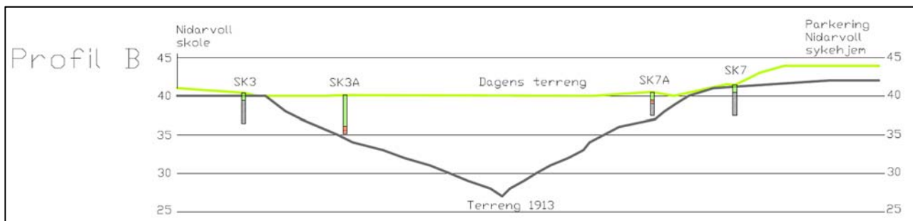
Figur 5 Eksempel på tverrsnitt som viser opprinnelig terreng (basert på kart fra 1913) og dagens terreng. Eksempelet viser et område mellom Nidarvoll skole og Nidarvoll sykehjem. Kilde: Utsnitt fra tegning 413910-10.
