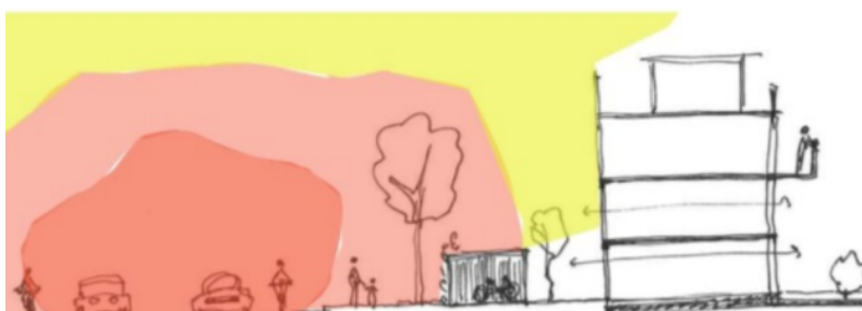
Prinsippskisse for forhage som støyskjerming.
