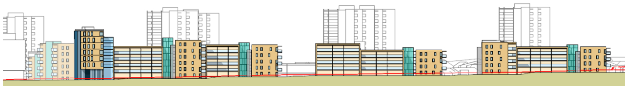
Ny bebyggelse sett fra Kong Øysteins veg i sammenheng med eksisterende boligblokker. Fasadtetegningen viser vindu og balkonger. Det tillates ikke svalegang mot offentlig veg.
