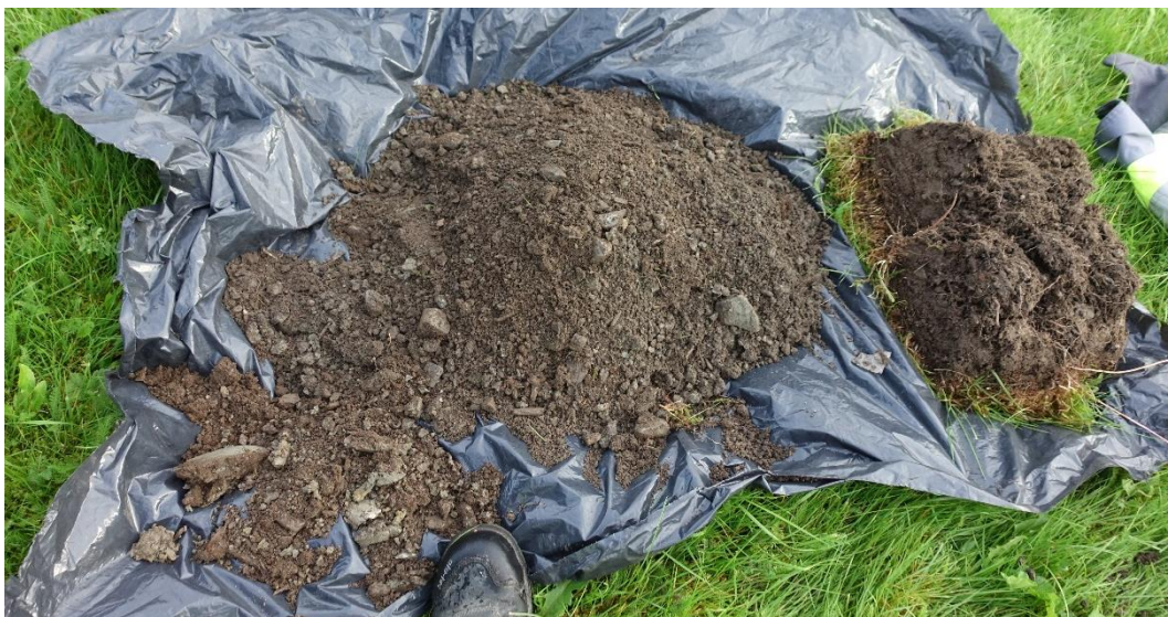
Figur 2.3 Bildet viser massene fra VA1. Massene består av jord med noe søppel i form av glass, keramikk og metall i øverste halvmetr.
