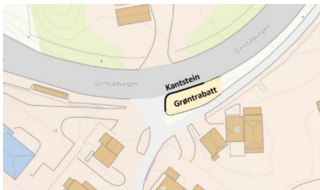
Figur 16: Utforming av kantsteinsavgrenset grøntrabatt
