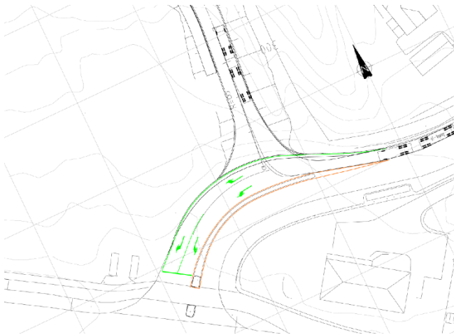
Figur 15: Vegløsning i kryss med økt lengde på midtdeler, dobbel sperrelinje og sporingsdiagram for vogntog gjennom avkjørselen.
