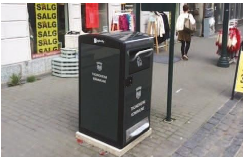
Figur 13: Komprimerende avfallsbeholder, Bigbelly, plassert i Thomas Angells gate. Foto: Trondheim kommune.
