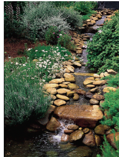
Figur 31. Variert utforming i og langs bekk, med muligheter for å komme ned til vannet. Lite fall på bekken gjør at terskler må bygges lave.
