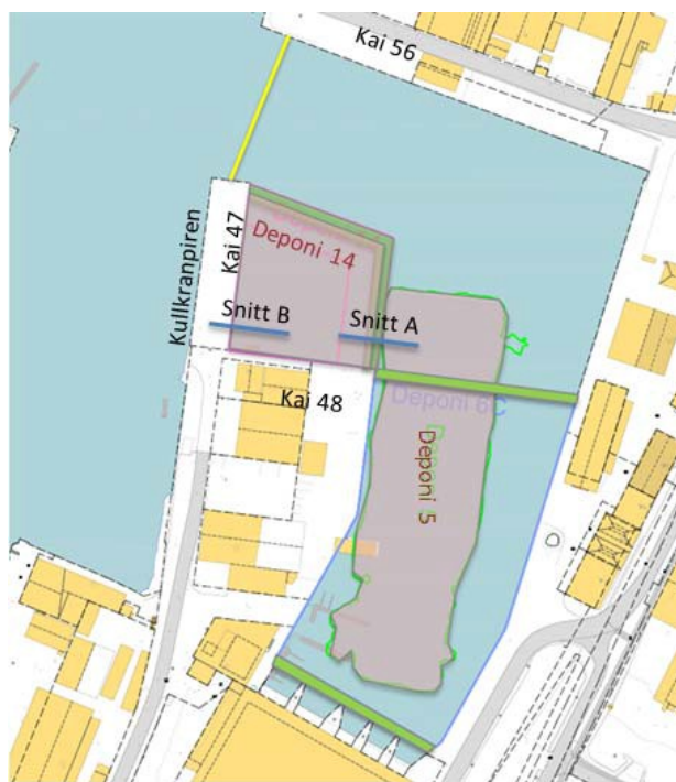
Figur 2: Forsvarlig deponering av mudringsmasser kan gjøres i sjøbunnsdeponi (deponi 5), kaikantdeponi (deponi 14) og ved å heve sjøbunnen avgrenset med to undervannssjetéer markert med grønne linjer i kartet.
